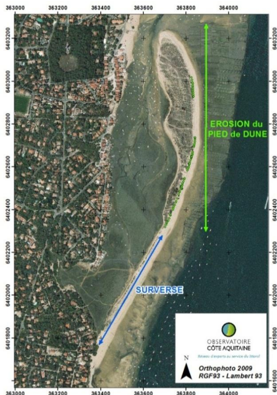
Figure 58 - Observations au niveau de la flèche sableuse du Mimbeau (BRGM).
