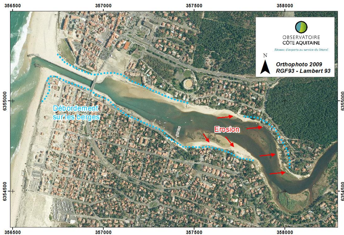
Figure 36 - Débordement sur les berges et forte érosion en amont du courant (BRGM).
