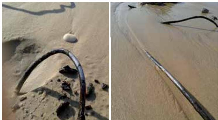
Cette barre fait partie de vestiges abandonnés lors de la démolition du blockhaus, de toute évidence des armatures du béton. **Des armatures en acier inoxydable !**
